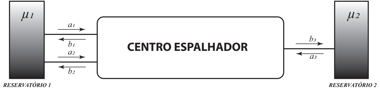
Figura 1.3: Problema de espalhamento com dois terminais. O centro espalhador está ligado a dois terminais com potenciais eletroquímicos \mu_1 e \mu_2 através de dois guias com três canais abertos. Os valores de a e b representam as amplitudes das ondas incidentes e as amplitudes das ondas que saem, respectivamente, do condutor.
