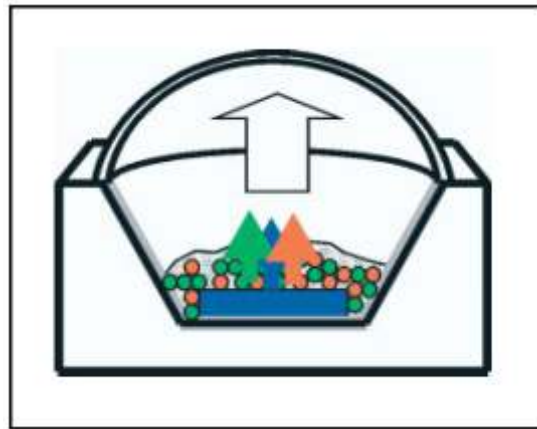
Figura 1.3: Primeiros fósforos aplicados em LEDs. Esses fósforos são colocados na parte superior do LED para a conversão de luz azul numa mistura de cores para a geração de luz branca.
