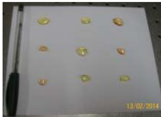
Figura 2.6: Amostras de vidros fluorogermanatos dopados com íons terras-raras produzidas no laboratório de Química e Física do departamento de Física-UFRPE.
