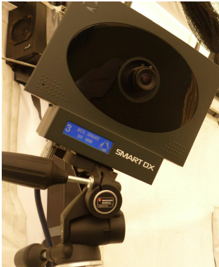
Figura 3.3: Uma das seis câmeras de detecção de movimento BTS Smart DX 400. Sistema optoeletrônico de câmeras digitais com iluminação infravermelho.(referencia BTS smart). Imagem cedida pelo Grupos de pesquisa em Engenharia Biomédica, Ciências Básicas e Laboratórios, Universidade Manuela Beltrán.
