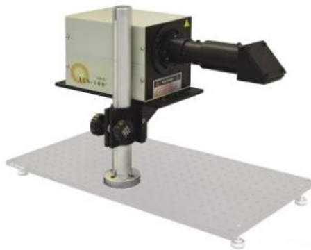
Figura 20 – Modelo do simulador solar, Oriel LCS – 100.
